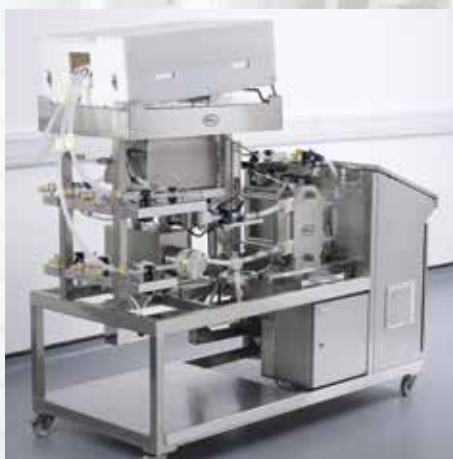
Тангенциальная одноразовая фильтрационная установка PALL Allegro™, в которой насос Quattroflow QF1200SU используется в качестве рециркуляционного.
