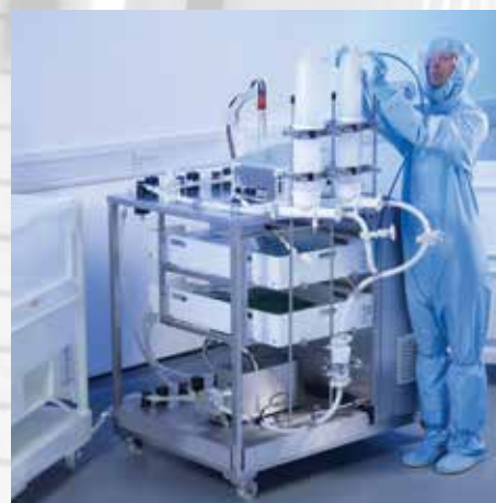
Одноразовая производственная установка PALL Allegro™ MVP, также оснащенная насосом Quattroflow QF1200SU и используемая для различных целей, как напр. антивирусная фильтрация, стерильная фильтрация, мембранная хроматография и т.п.
